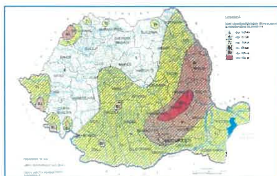
Fig. 2 SR 11100/1-93 – “Zonarea seismică. Macrozonarea teritoriului României”
